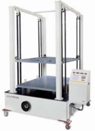
图 2 XYD-15K 纸箱抗压试验机
